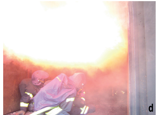
Abb. 25: Rauchschiebungsexplosion im Raum vor dem Brandraum (Fotos: Fuchs, Wuppertal)
