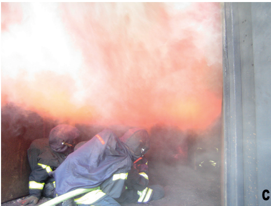
Abb. 25: Rauchschiebungsexplosion im Raum vor dem Brandraum (Fotos: Fuchs, Wuppertal)
