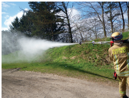
Abb. 58: Die Tropfengeschwindigkeit, Wurfweite und Strahlform haben eine große Bedeutung (Foto: Fuchs)
