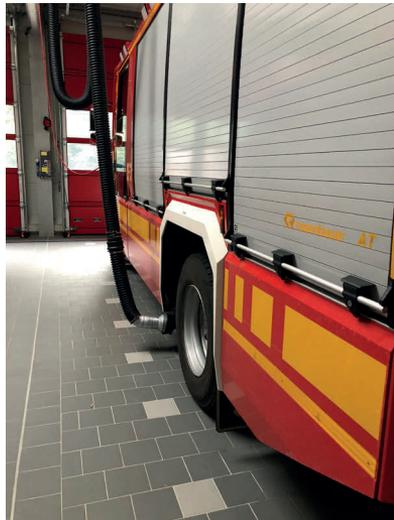
Abb. 52: korrekt aufgesetzte Quellenabsaugung (Quelle: Marcus Bätge)
