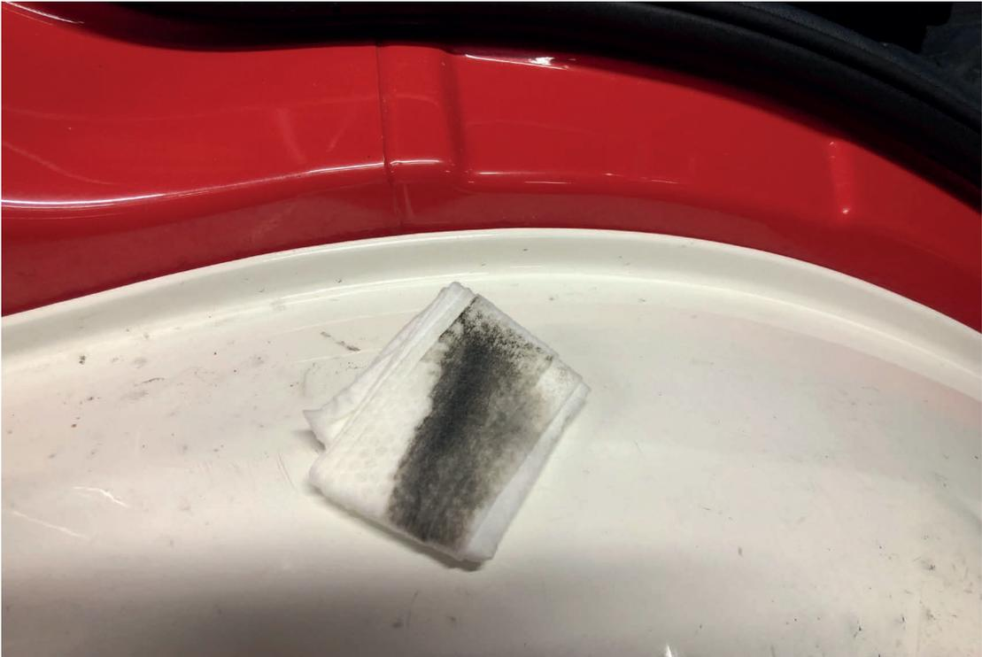
Abb. 53: Wischprobe von der Sonnenblende eines Löschfahrzeuges (Quelle: Marcus Bätge)
