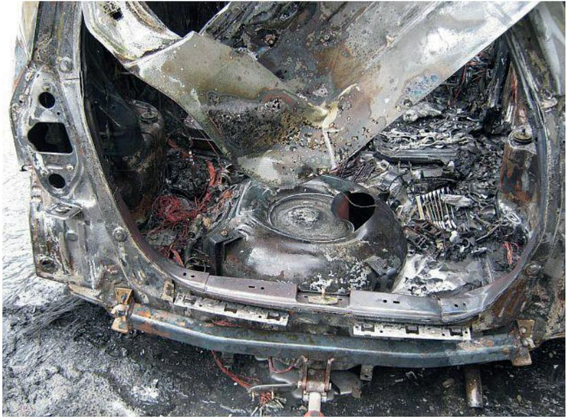
Abb. 16: Aufgerissener LPG-Tank nach Brandeinwirkung.
