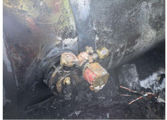
Abb. 144: Multiventil nach Flammenbeaufschlagung. (Quellen: Löschzug Haaren)
