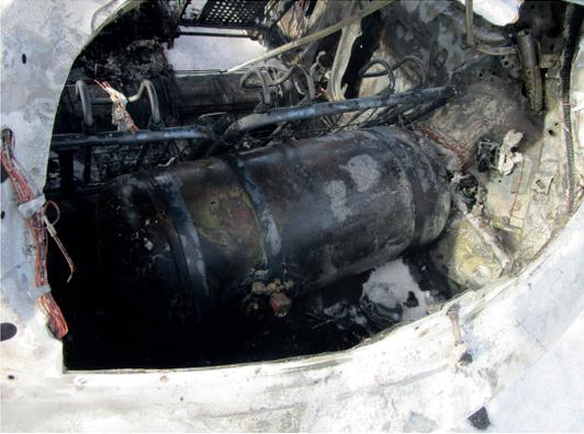
Abb. 143: Fahrzeugbrand mit Flüssiggastank. (Quelle: Löschzug Haaren)
