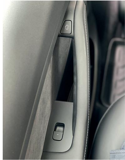
Abb. 140: fehlende Notentriegelung in den hinteren Türen eines TESLA Model 3. (Quelle: Tanja Hellmann)
