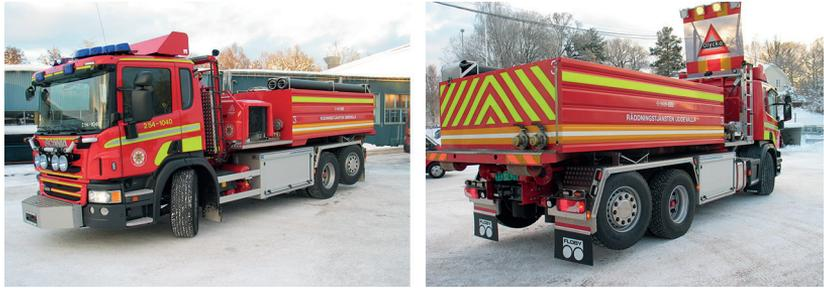
Abb. 4: In Skandinavien längst Standard an vielen Standorten: WLF mit TS und 6.000 bis 8.000 L Löschmittel (Quelle: Autokarross AB)
