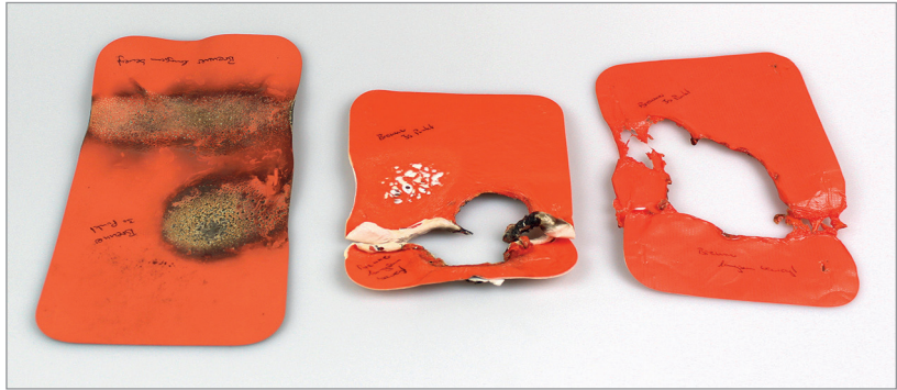
Abb. 17: Verhalten von Anzugmaterial bei direkter Beflammung mit Löt- lampe von 3 Sek.: Wiederverwendbar – Limited Use – Spritzschutzanzug (v. l. n. r.)
