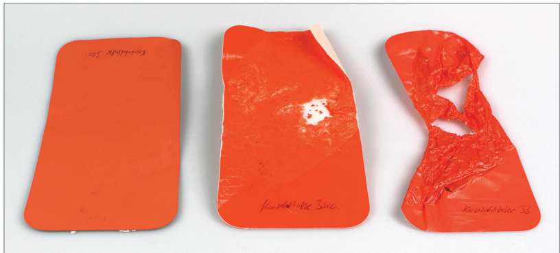
Abb. 19: Verhalten von Anzugmaterial bei Kontakthitze durch Bügelei- sen von 3 Sek.: Wiederverwendbar – Limited Use – Spritzschutzanzug (v. l. n. r.)
