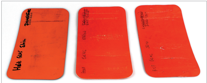
Abb. 18: Verhalten von Anzugmaterial bei Bearbeitung mit scharfkanti- gen/rauen Materialien (Holz, Glas, Stein, Blech): Wiederverwendbar – Limited Use – Spritzschutzanzug (v. l. n. r.)
