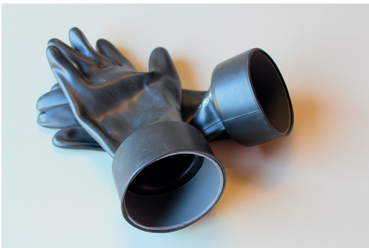
Abb. 13: Chemikalienschutz-Handschuhe mit eingeschobenen Rohrstücken, vorbereitet für den Einsatz
