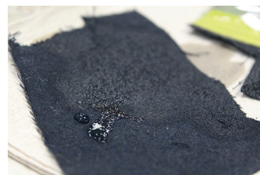
Abb. 12: Durchdringungsverhalten bei geschädigtem Obermaterial (fehlende Imprägnierung)
