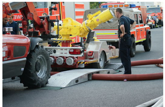
Abb. 157: Nachträglich verlegte Schlauchbrücken für die Größe „F“ oder größer sind aufgrund der zum Überqueren nötigen Rampen- bzw. Überhangwinkel bzw. wegen der erforderlichen Bodenfreiheit für viele Fahrzeuge bereits unüberwindliche Hindernisse. Hier muss ein FwA mit einem Großwerfer mittels Teleskoplader über die Schlauchbrücke gehoben werden. (Bahnstrecken müssen dann ggf. gesperrt werden!) (Foto: Nottebrock, Neuss)
