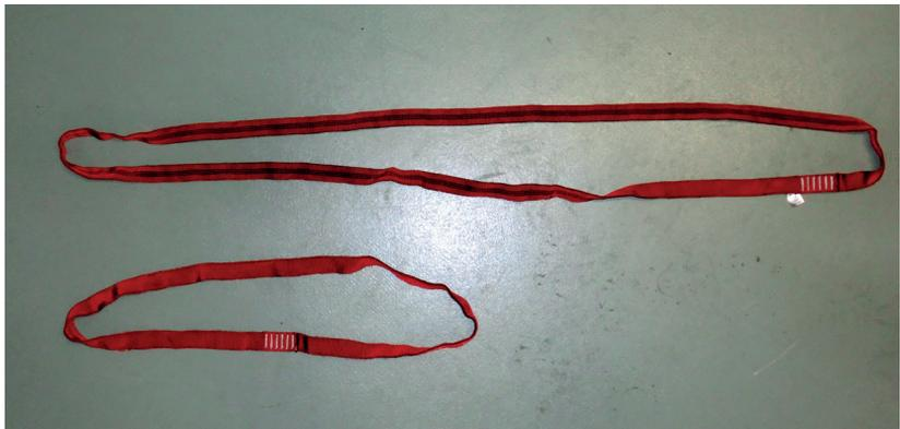
Abb. 16: Beispiele für Bandschlingen nach EN 354/EN 795B. (Quelle: Werft)
