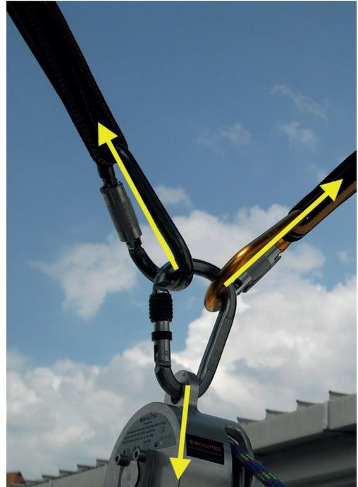
Abb. 14: Ungünstige Belastung eines Karabiners. Hier werden die entstehenden Kräfte an den Rundungen des Karabiners in diesen eingeleitet, wodurch eine Belastung in Querrichtung entsteht. In dieser Richtung weisen Karabiner eine geringere Festigkeit als in Längsrichtung auf. (Quelle: Werft)
