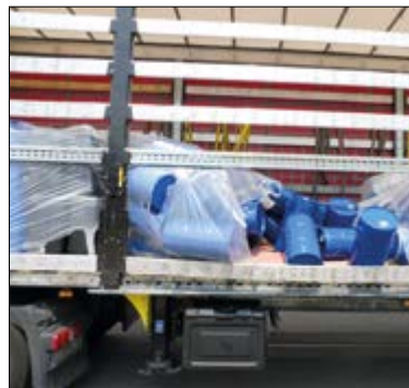
Die Art der eingesetzten Verpackung beeinflusst auch die Ladungssicherung beim Transport. Stabile Ladeeinheiten sind dafür eine Voraussetzung.
