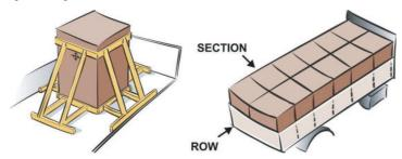
1.1.3 Die Summe der Freiräume soll in jede horizontale Richtung nicht mehr als 15 cm betragen. Bei schweren und starren Ladungsteilen, wie Stahl, Beton oder Stein, sollen die Freiräume weiter reduziert werden und so gering wie möglich sein.
