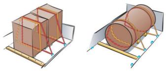
Für die Sicherung langer Ladungsteile mit Bucht-Laschings sind mindestens zwei Paare zu verwenden, um die Ladung auch gegen Torsion zu sichern.
